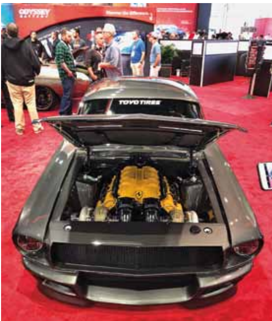
„Corrupt Mustang“ aneb co se stane, když vezmete 1968 Mustang Coupe a dovnitř umístíte motor Ferrari V8, který dostane rovnou 2 turbodmychadla
