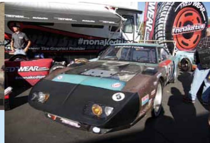
Projekt „Scraptona“, který vznikl na základě Chargeru rozebraného na díly, který byl postupně doplněn částmi z jiných aut, postaven na závodním chasis a poháněn originál NASCAR motorem R5 od Richarda Pettyho
