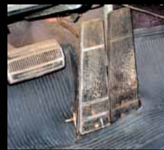
Nezvyklé ovládání dvěma plynovými pedály: noha vlevo – přední motor, noha přes oba pedály – oba motory
