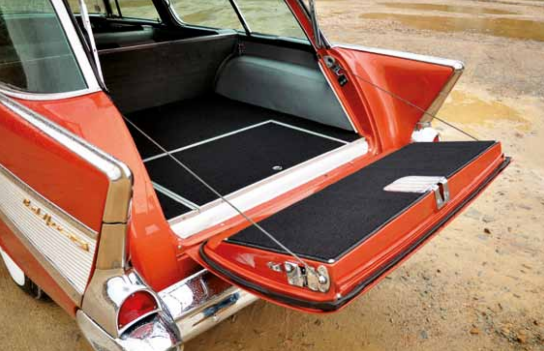
Způsob otevírání zavazadelníku se z dnešního pohledu může zdát nepraktický, ale koncem 50. let to byl výrazný trend
