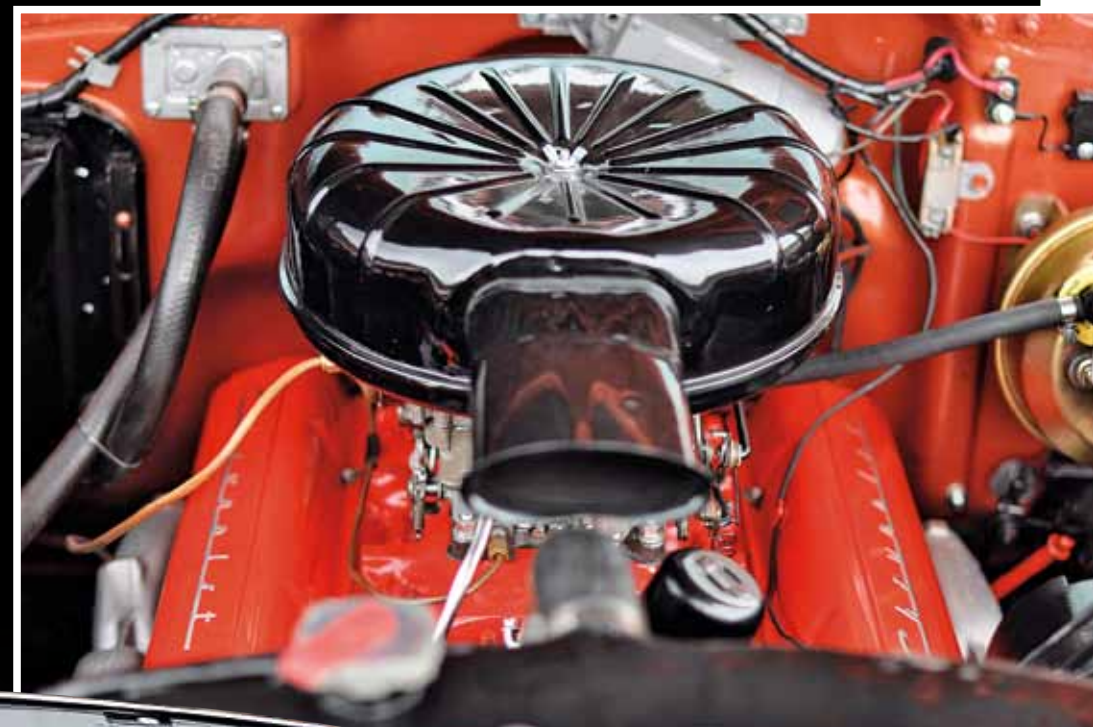
Zvětšený vidlicový osmiválec „Turbo Fire 283“ byl novinkou modelového roku 1957 a disponoval výkonem 185 koní
