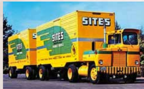
Koncepce CBE (Cab Beside Engine) sice není výlučným majetkem Kenworthu, přesto je poměrně vzácná. Nesetkáte se s ní v dálkové dopravě, ale v přetahu semi-trailerů v průmyslových areálech, překladištích a přístavech. Je to nejskromněji vybavený tahač, Kenworth jej uvedl na trh v polovině padesátých let. Větší verze měly tři nápravy
