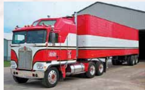
Nádherný exemplář řady K100, dodávaný od poloviny 60. do poloviny 80. let. Obvyklá nabídka agregátů Detroit Diesel, Cummins a Caterpillar o výkonu až 520 koní a převodovkami Fuller nebo Allison. V sedmdesátých letech modernizovaný (K100C). Po posledním faceliftu v roce 1984 se řada nazývala Series K100E. Klasický „Ken“, který se stal základem mnoha fascinujících přestaveb
