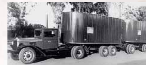
Kenworthu patří prvenství v sériové montáži vznětových agregátů na americkém území. Na snímku je zástupce první takto vybavené řady, doplněný semi-trailerem a trailerem. Je zajímavé, že velké návěsy se ještě ve větší míře neuplatnily, přepravce raději volí komplikovanější způsob
