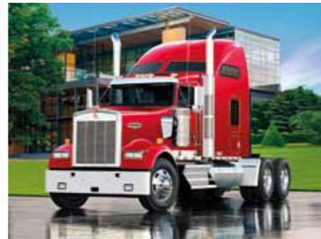
Nádherný exemplář řady K100, dodávaný od poloviny 60. do poloviny 80. let. Obvyklá nabídka agregátů Detroit Diesel, Cummins a Caterpillar o výkonu až 520 koní a převodovkami Fuller nebo Allison. V sedmdesátých letech modernizovaný (K100C). Po posledním faceliftu v roce 1984 se řada nazývala Series K100E. Klasický „Ken“, který se stal základem mnoha fascinujících přestaveb
