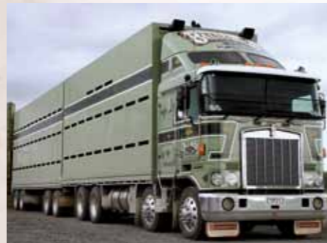
Koncepce CBE (Cab Beside Engine) sice není výlučným majetkem Kenworthu, přesto je poměrně vzácná. Nesetkáte se s ní v dálkové dopravě, ale v přetahu semi-trailerů v průmyslových areálech, překladištích a přístavech. Je to nejskromněji vybavený tahač, Kenworth jej uvedl na trh v polovině padesátých let. Větší verze měly tři nápravy
