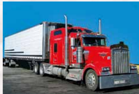
Exkluzivní W900, od prvního do posledního šroubku poskládaný podle detailní truckerovy objednávky. Spací box je prosklený i ve zvyšné nástavbě, vztah majitele ke svému trucku dokumentuje i tradiční americký pinstriping. Určitou zajímavostí je dlouhý rozvor podvozku semi-traileru
