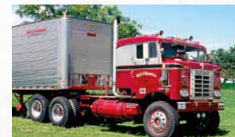
Populární a oprávněně uctíváný „Bullnose“ sjížděl z pásů v letech 1948 až 1956. Používal chassis řady 500, mohl mít konfiguraci 4x2, 6x4 nebo 6x2. Samozřejmostí byla volba mezi krátkou kabinou a továrním sleepboxem (na snímku)
