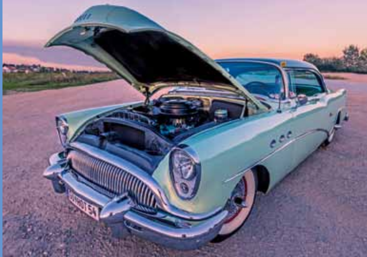
Nailhead V8 byl v roce 1954 naprostou novinkou, ještě před dvěma roky byl na jeho místě antikvární řadový osmiválec
