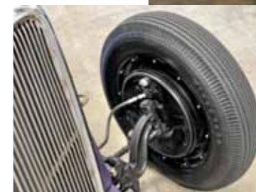
Přední brzdy jsou replikou lincolnových bubňů ročníku 1939, stavěnou u Bendixe
